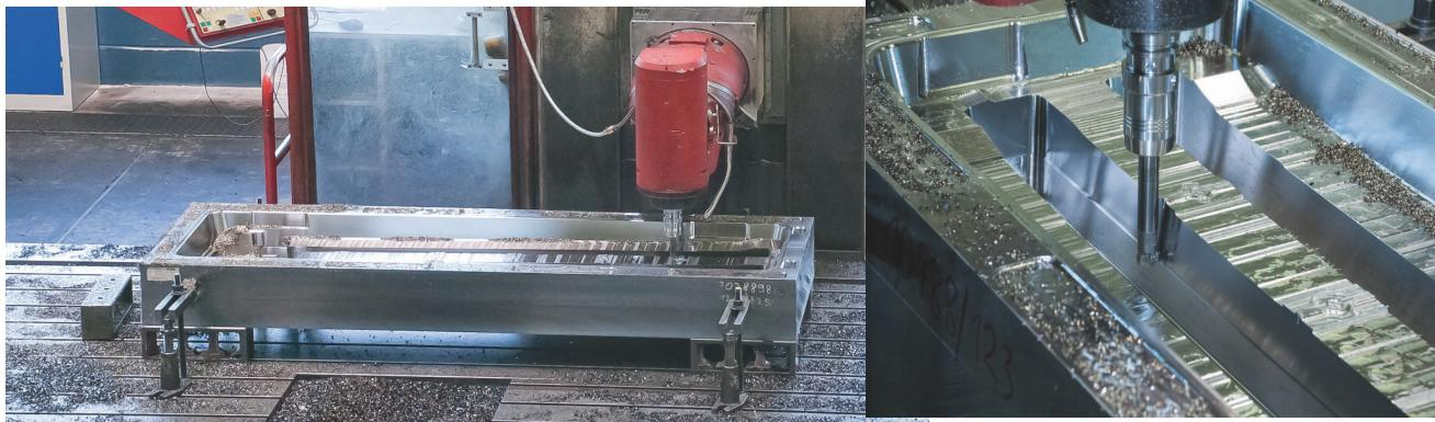
Fräsen im XL-Format: Auf der großen Mecof-Fahrständermaschine sorgt der Wendeplatten-Tonnenfräser ebenfalls für enorme Zeitvorteile. Hier der GF1 beim Abzeilen der Schrägen.
