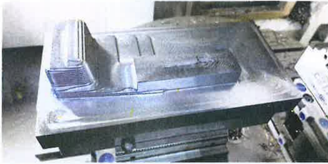
40 Prozent Zeitersparnis: Der schwierig zu spanende Schieber nach dem 3-achsigen trochoidalen Schrumpfen mit dem EPSM. Anschließend wurden in einem Arbeitsschritt mit dem Kugelfräser EHHB alle Treppen entfernt und auf 1/10 Millimeter vorgeschlichtet. Das Feinschlichten mit Z-konstant übernahm dann der Kugelfräser HGOB. (Bild: MMC)
