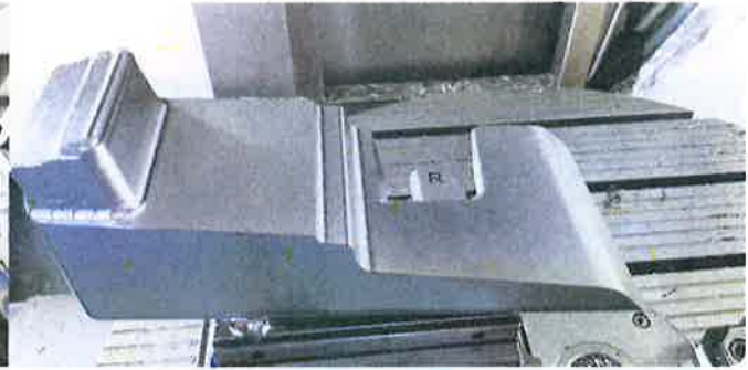
40 Prozent Zeitersparnis: Der schwierig zu spanende Schieber nach dem 3-achsigen trochoidalen Schrumpfen mit dem EPSM. Anschließend wurden in einem Arbeitsschritt mit dem Kugelfräser EHHB alle Treppen entfernt und auf 1/10 Millimeter vorgeschlichtet. Das Feinschlichten mit Z-konstant übernahm dann der Kugelfräser HGOB. (Bild: MMC)
